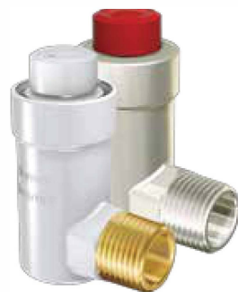
Flexvent H Radyatör bağlantıları için Otomatik Radyatör Purjörü 1/2" PN10 -120°C Şamandıralı
